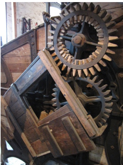
Holzzahnräder an Waschmaschine 1870
